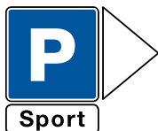
Hinweiszeichen E.5 (Anlage 7) mit Zusatztafel und Richtungspfeil
