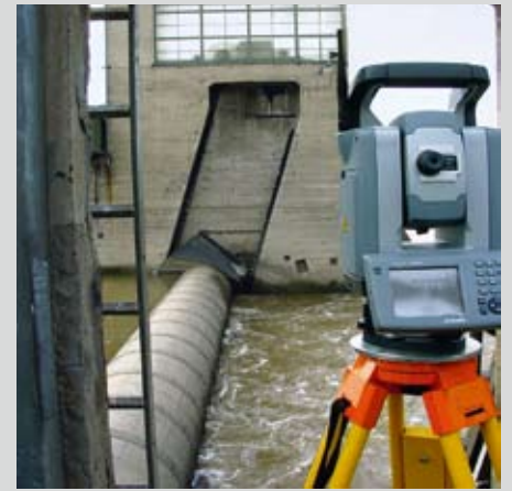
Abstandsmessungen mittels elektro-optischer Totalstation
