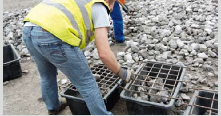
Baustoffprüfung der Wasserbausteine
