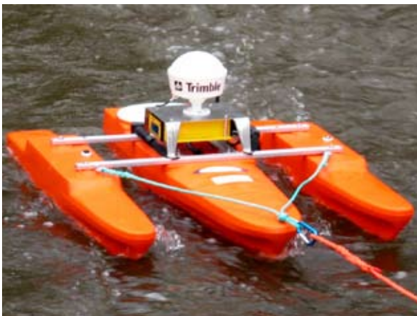
Trimaran für mobile Durchflussmessungen von Brücken usw.
